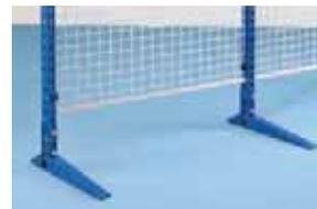
Der Stützfuß wird mit Dübeln im Boden verschraubt. Ein Stellfuß in der Stütze ermöglicht einen Niveaueausgleich um 28 mm. Bei kragenden Anbauelementen ist die Verwendung des 400 mm langen Fußelements erforderlich.
