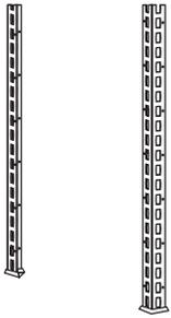
Systemprofil mit Lochung im Höhenraster 30 mm. Winkelprofil 30 x 30 x 1,5 mm. Markierungslochung im Höhenraster von 90 mm für schnelle Montage. Einschließlich schwarzem Kunststofffuß.
