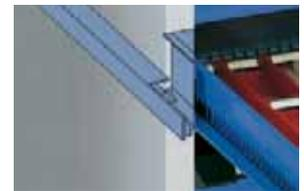
Auch innerhalb eines Gehäuses kann zwischen Einfach- und Vollauszug variiert werden: Einfachauszug E 80, 80% Auszug, belastbar bis max. 80 kg, Vollauszug V100, 100% Auszug, belastbar bis max. 100 kg, Vollauszug V200, 100% Auszug, belastbar bis max. 200 kg Umrüstung jederzeit möglich!
