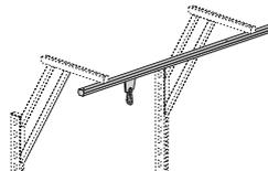
Mit Werkzeugwagen und Karabinerhaken, 2 verstellbare Endanschläge
