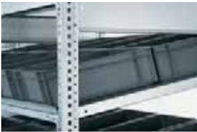
Die Fachböden, 800 mm tief, mit vorderem Anschlag liegen auf gesteckten Bodenträgern; Höhenverstellung im Raster von 30 mm. Neigungswinkel 10°
