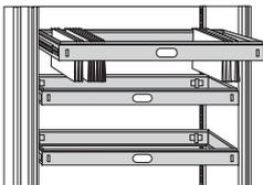
Auf Teleskopschienen mit Vollauszug und manueller Auszugssperre, 2-bahnig 80 kg belastbar, (2 Fachböden je Lagerebene erforderlich, Bodennutztiefe = Bodentiefe minus 100 mm)
