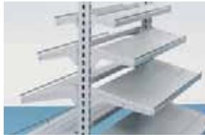
Leicht zu verstellende Lamellenböden im oberen Arbeitsraum. Verstellraster 42 mm. Tiefen der Lamellenböden: 107, 214, 321, 428 und 535 mm. Neigung +10° und -16°.
