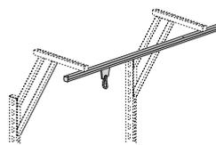
Mit Werkzeugwagen und Karabinerhaken, 2 verstellbare Endanschläge inkl. Befestigungsmaterial
