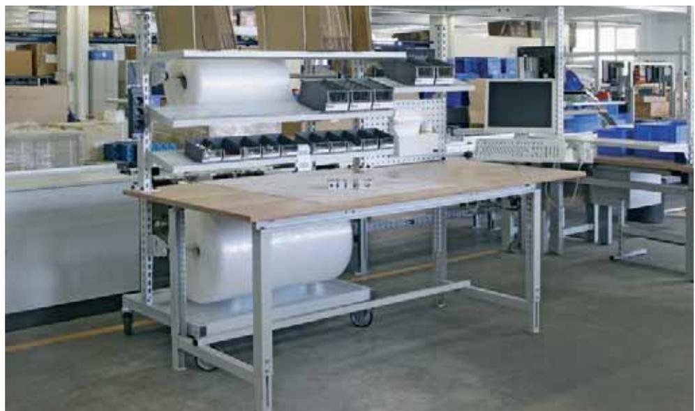
**Packarbeitsplatz** mit Lamellenböden, Trennbügeln und Rollenhaltern
