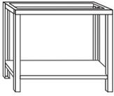
Lichte Einbauhöhe 600 mm, lichte Höhe unter Grundboden 125 mm
