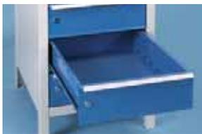
Die Schubladen sind seitlich im Abstand von 75 mm geschlitzt, zur Aufnahme von Fachteilern. Drehzylinderschloss je Werkbank gleichschließend. Auszug bis 80%, belastbar bis max. 60 kg. Kugelgelagerte Schubladen, gegen Herausfallen gesichert.
