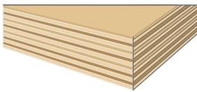
aus mehrschichtig verleimtem Buchenholz, phenolharzverleimt, mit Leinölfirnis gegen Verschmutzung, für den „robusten Einsatz“
