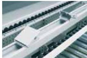
Der sichere Halt für den Werkstückträger. Durch Kipp-Stopper wird der Werkstückträger für die Dauer der Montage an Ort und Stelle gehalten. Manuelle Auslösung ermöglicht einen schnellen Weitertransport der Montageteile.
