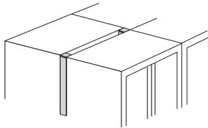
aus 30 mm Vierkantröhr ermöglichen ausreichende Luftzirkulation bei Rücken-an-Rücken-Aufstellung
