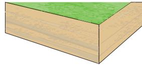
2 mm Linoldeckschicht, hellgrün marmoriert, Belag permanent antistatisch, hoch abriebfest, mittelhart. Buchenumleimer 4 mm dick
