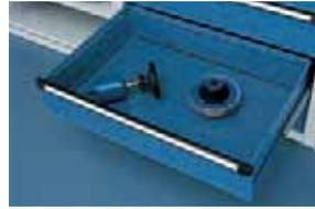
Ausziehboden auf Teleskopschienen 100%-Auszug, dreiseitiger Abrollrand, belastbar bis 100, bzw. 200 kg, Höhe 120 mm, lackiert, Abstandshöhe zum nächsten Boden: 150 mm
