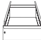
zur Befestigung in offenen Unterbauten, Belastung 60 kg, 80 % ausziehbar, Innenmaß B x T x H: 390 x 600 x 126 mm
