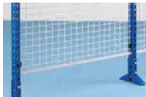
Allseitig gelochtes Rohr B x T x H: 30 x 60 x 2320 mm zur Aufnahme von Zubehör. Höhenraster 42 mm, mit Abdeckkappe aus Kunststoff, Höhenverstellung und Befestigung mittels Bodenanker. Rahmenschiene oben/unten: Stabilisierungs- und Montagehilfe.
